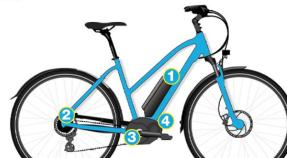
1 Asistencia eléctrica 2 Potencia max 250W 3 Velocidad max 25 km/h 4 Pedal asistido
